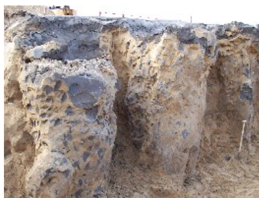
Abb. 2-2: Versuchsfeld der BUL Sachsen GmbH, Säulen bis 5 m unter GOK freigelegt (links) mit Aschesäulen der Aschesuspension 1,6 \text{ t/m}^3 (rechts)
