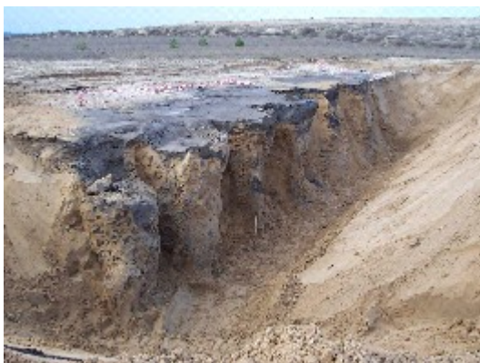
Abb. 2-2: Versuchsfeld der BUL Sachsen GmbH, Säulen bis 5 m unter GOK freigelegt (links) mit Aschesäulen der Aschesuspension 1,6 \text{ t/m}^3 (rechts)
