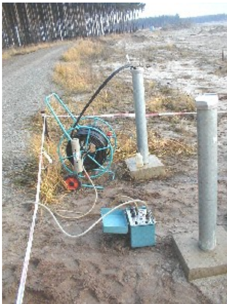
Abb. 4-10: Beprobung eines Pegels mit der Membranpumpe
