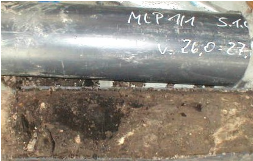
Abb. 5-2: Aufgesägter Liner aus dem Geschiebemergel des MLP1
